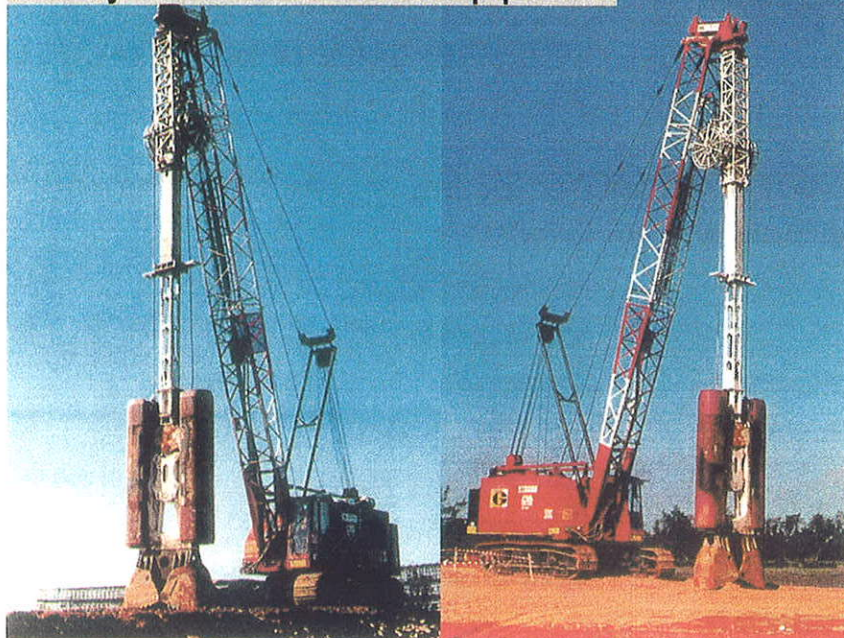
Fotos 2 y 3. Grúa Link Belt 280 con equipo BH-12
