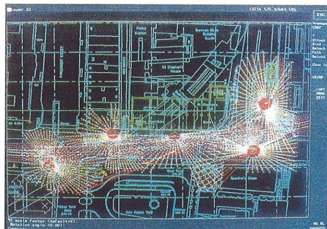
Fig. 7. Disposición de taladros en la estación de Westminster
