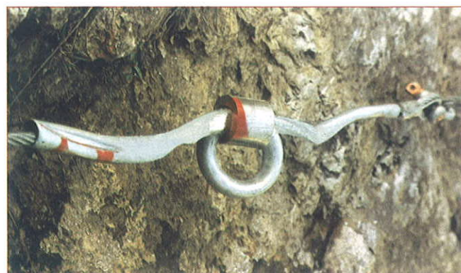
Fig. 23.- Dispositivo de frenado antes y después de la absorción de energía.
