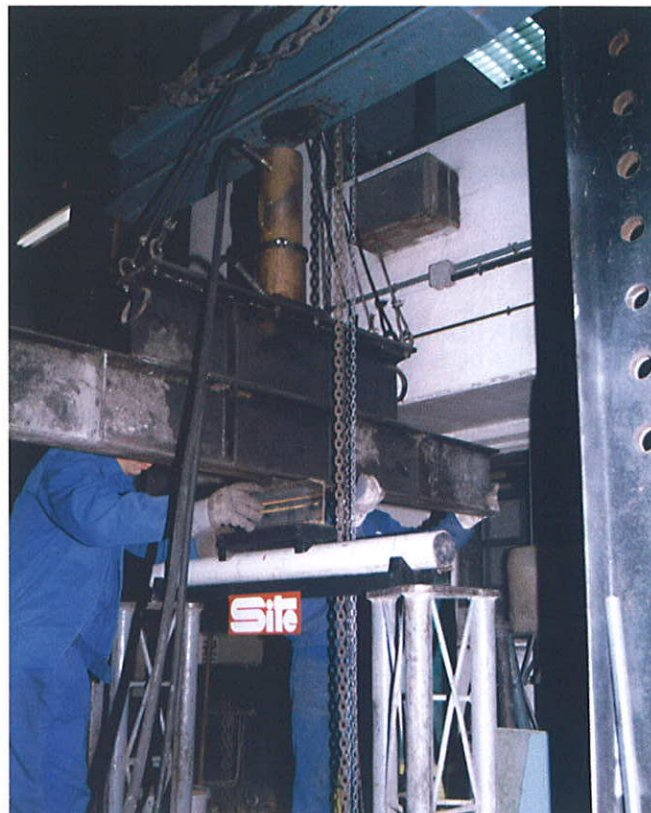
Fig. 10.- Preparación de un ensayo de tubería a flexión.
