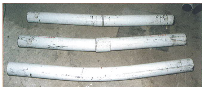
Estado de tres tuberías tras el ensayo a flexión.
