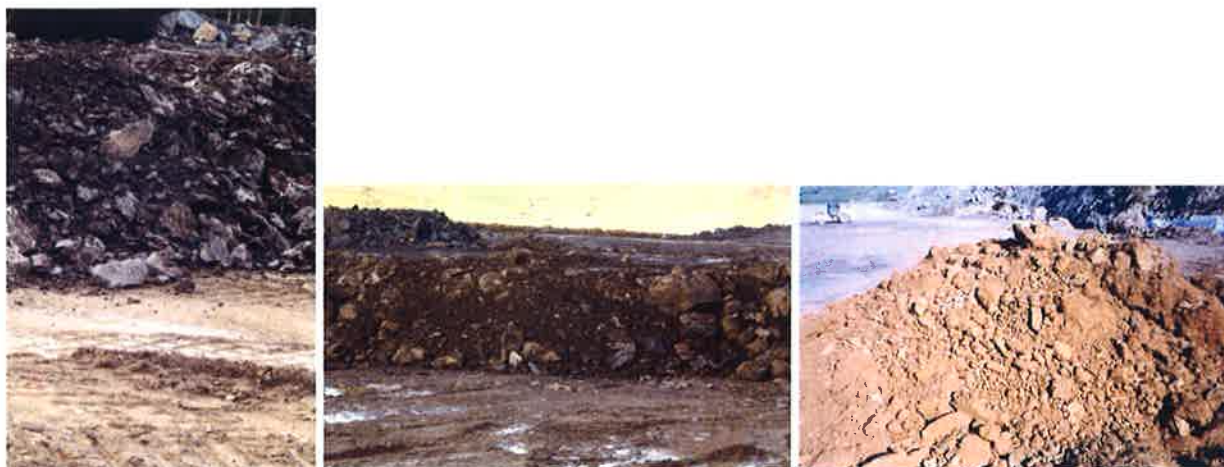
Detalle del pedraplén, todo-uno de calidad y todo-uno
