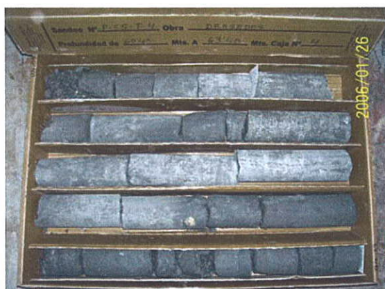
RESULTADO DE ROTURA DE LOS TESTIGOS EXTRAÍDOS DE LA INYECCIÓN DEL PILOTE 55
