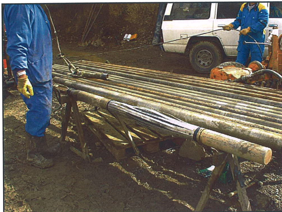
Foto 2.- Ensayo dilatométrico en el sondeo
