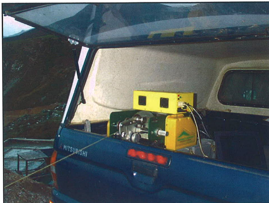
Foto 3.- Cabestrante y equipo de testificación geofísica por onda completa en sondeo
