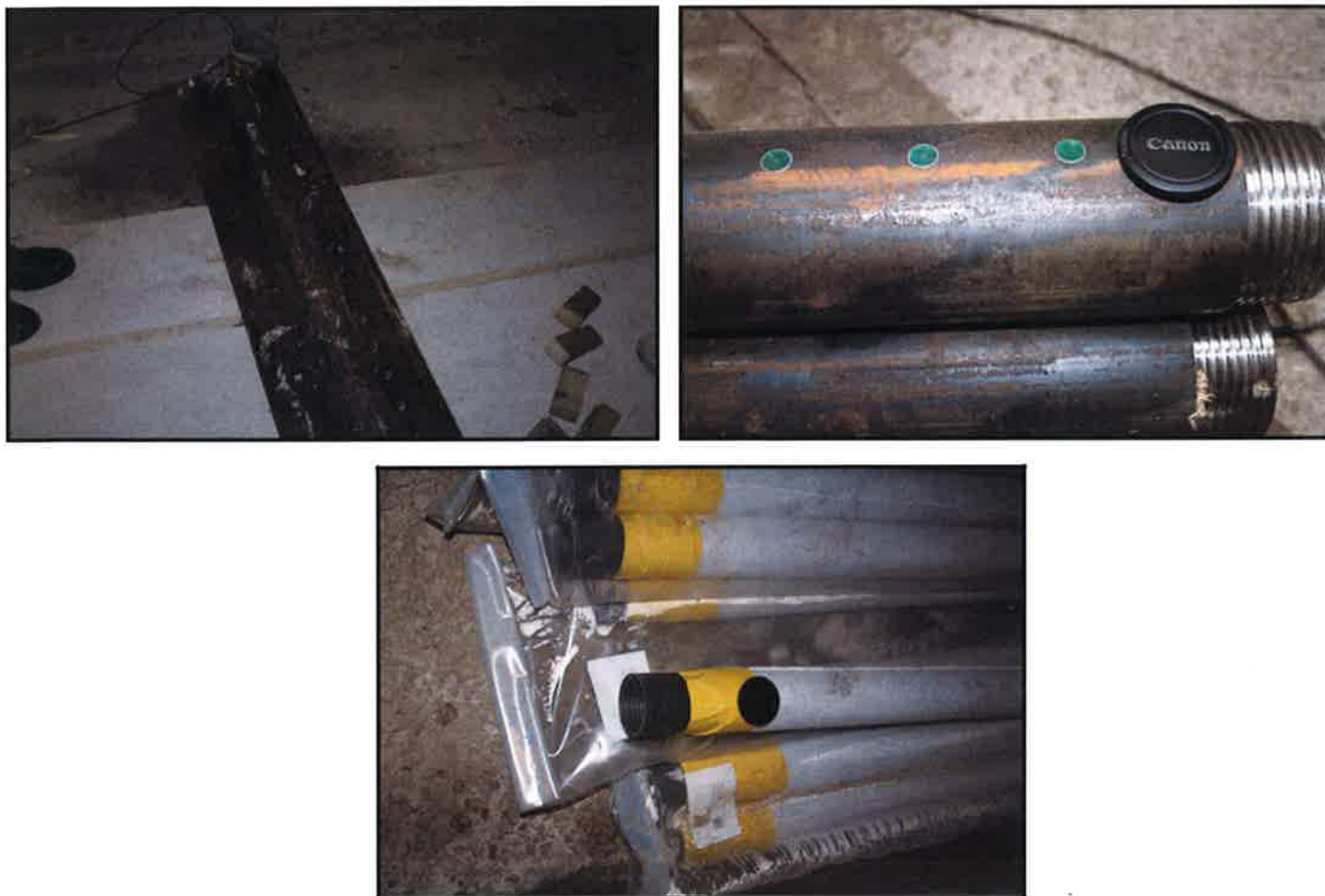
Foto 25. Tubo ranurado para los drenes horizontales.
