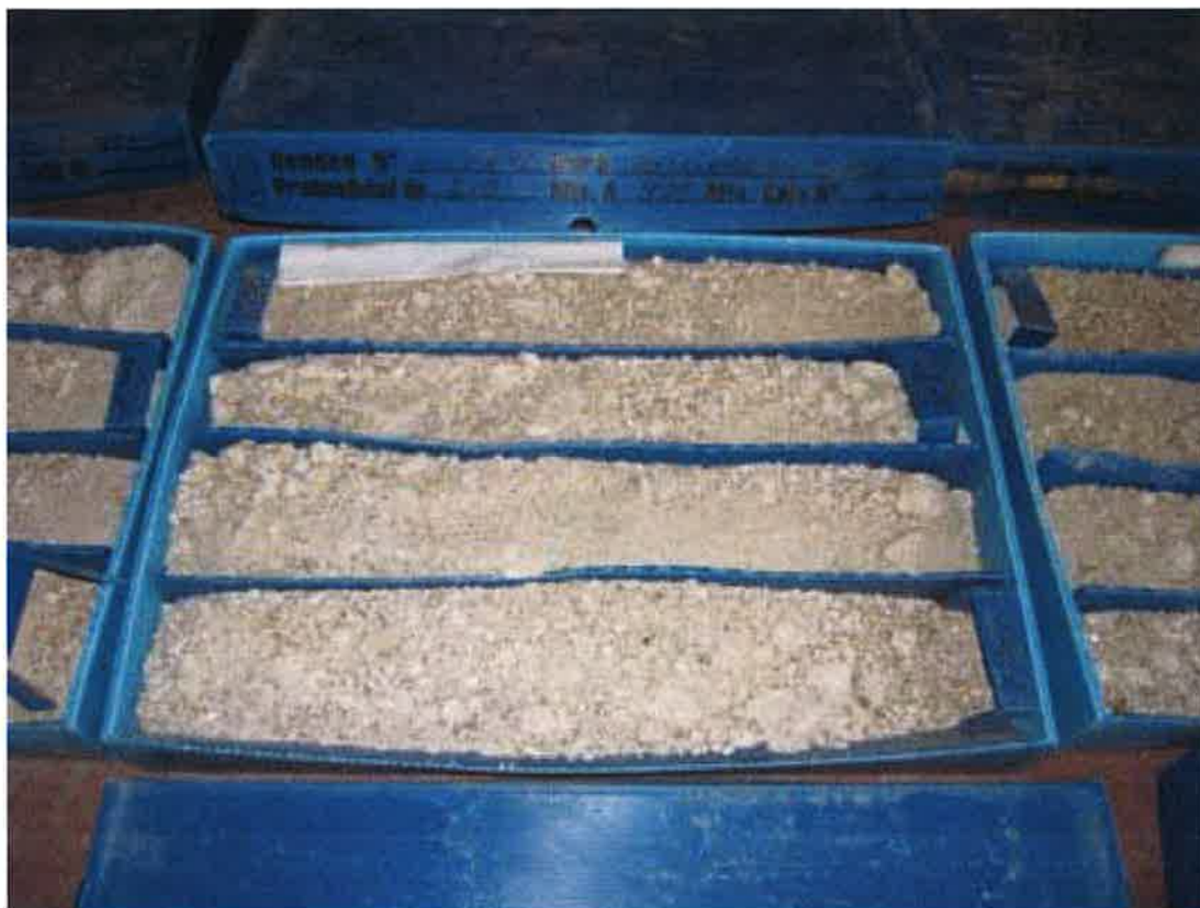
Fotografía n°5. Testigos de "jabre arena fina".
