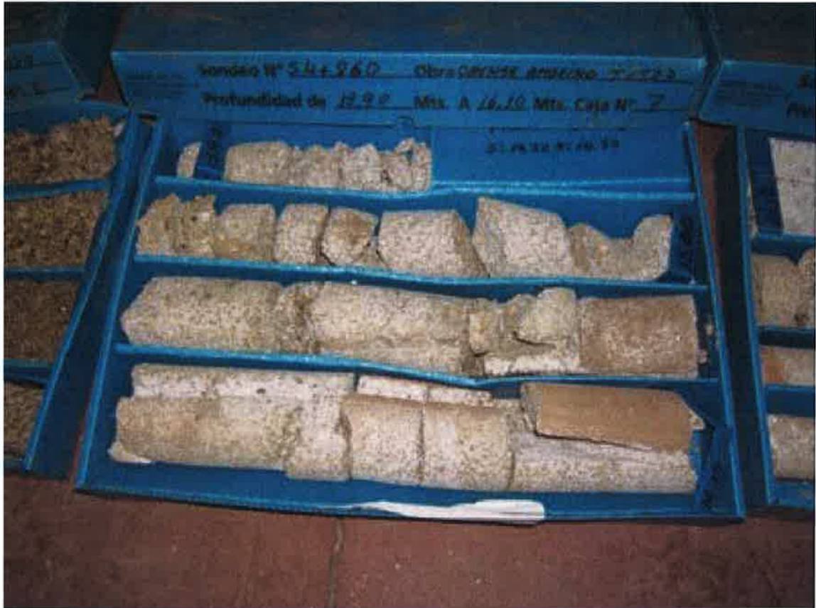
Fotografía nº2. Testigos de granito muy fracturado y con oxidación incipiente.
