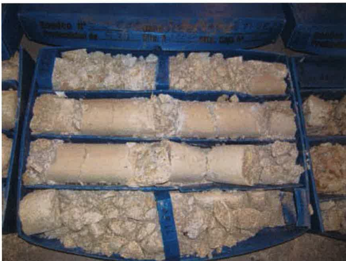
Fotografía nº4. Testigos de “jabre arcilloso”.
