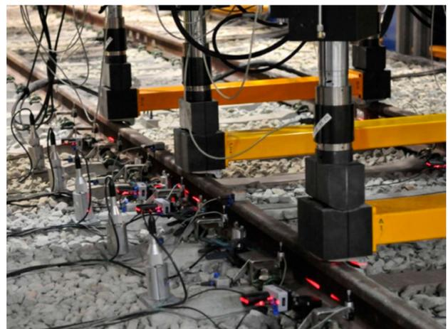
Foto 11. Cajón ferroviario del CEDEX (detalle de la instrumentación).
