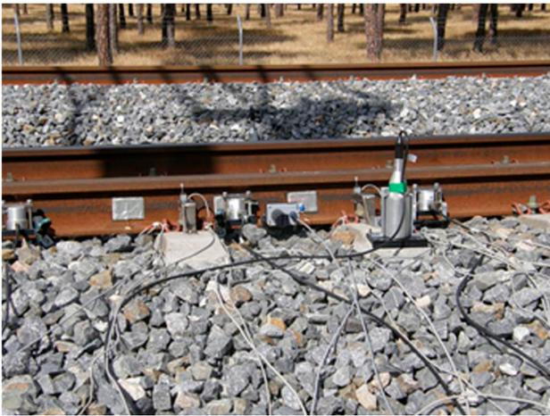
Foto 7. Instrumentación externa de sección bituminosa.
