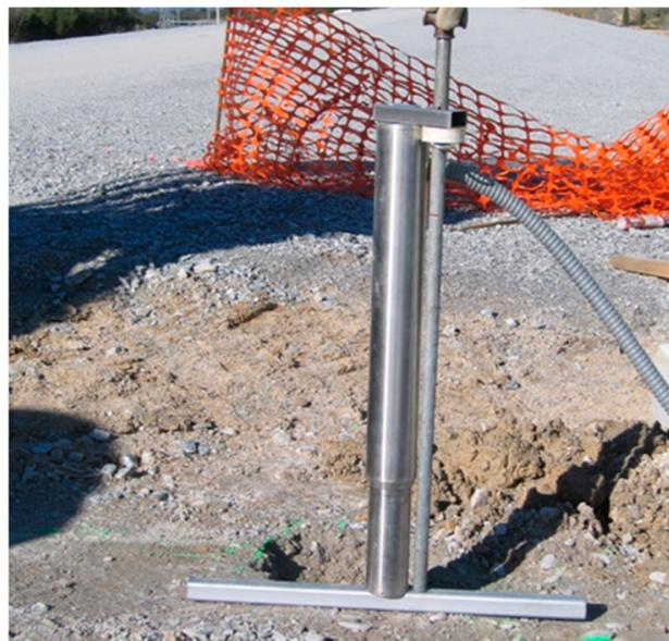
**Foto 5.** Sensor LVDT utilizado en la capa de balasto.
