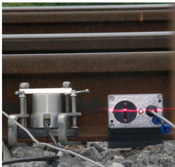
**Foto 2.** Sensor láser y geófono.
