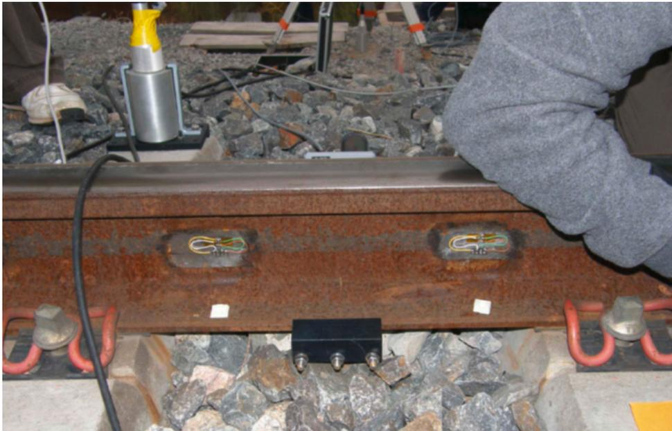
Foto 1. Colocación de bandas extensométricas en Cantoblanco.
