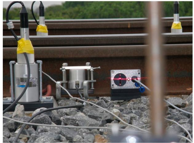
Foto 8. Medida de deflexiones en traviesa (geófono izquierdo) y carril (geófono central y láser).
