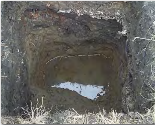
Figura 12. Calicata practicada en zona 1. Nivel freático a 3.50 m.
